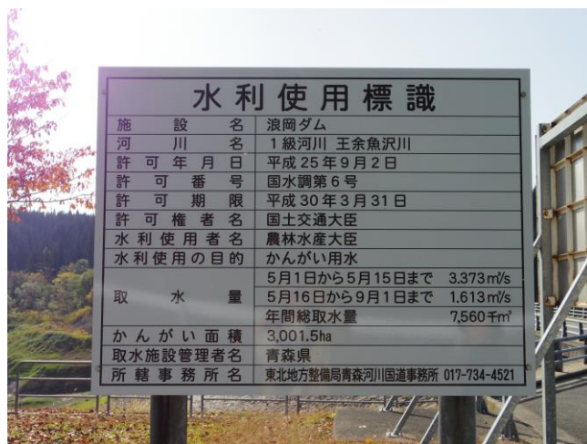
水利使用標識板
