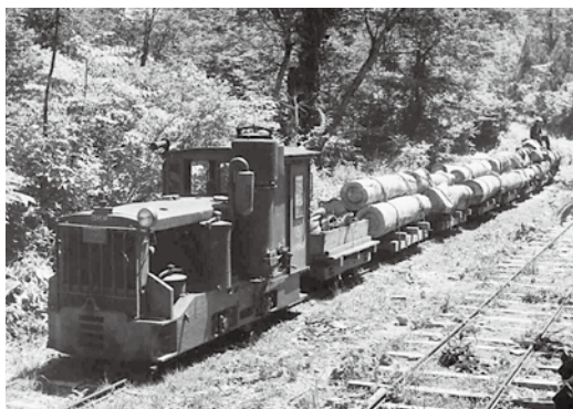
【写真③】津軽森林鉄道 木材をけん引するガソリン内燃機関車（木炭ガス発生装置付）（青森市教育委員会蔵）
